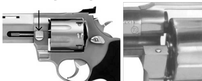
Figura 3 – Sistema de fixação do tambor reversível, em revólveres Taurus dotados de armação extra grande , por meio de uma presilha , localizada na região superior do suporte do tambor, com liberação através de pressão, para baixo, do botão ou tecla serrilhada
