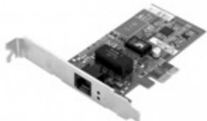
Placa de Rede (conexão a cabo)
