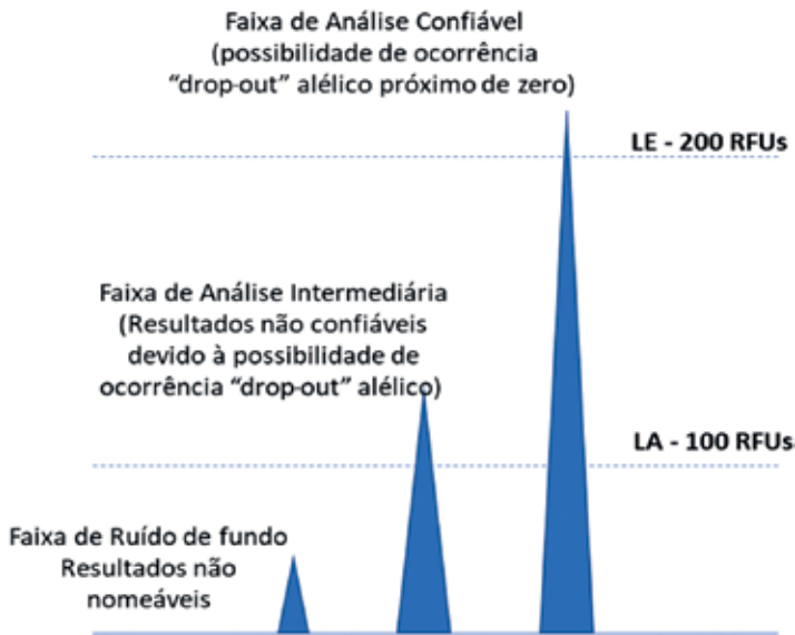
Figura 5. Representação esquemática de eletroferograma apresentando três exemplos de picos e os limiares analíticos (LA) e estocástico (LE). Os valores de LA e LE apresentados na figura são apenas para exemplificar; não provêm de análise laboratorial.
